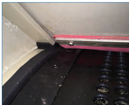
Innenansicht Trommelwäscher mit Gummilippe
